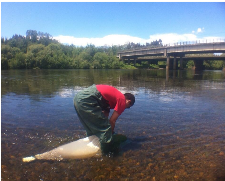
Figura 4.2.3.2. Uso de red Surber en río Cruces, sector Rucaco para muestreo de la macrofauna bentónica de fondos ritrales.
