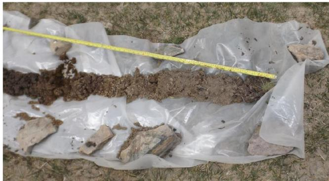
Figura 22: Muestras de suelo obtenidas a través de barreno (@Universidad de Chile, 2016).
