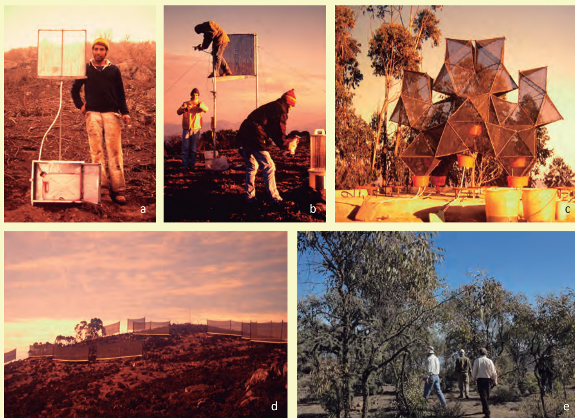
Figura 4.9 Atrapanieblas e investigación de la neblina en El Tofo: a b primeros neblinómetros utilizados en los inicios de las investigaciones de la niebla; c macrodiamante diseñado por el Profesor Carlos Espinosa; d atrapanieblas simples y dobles de 48 m 2 en 2 lugares de El Tofo en 1999; e parcela forestal en El Tofo plantada entre los años 1983 y 1992, regadas en sus inicios y que actualmente se autoabastecen mediante la intercepción de la niebla por su propio follaje.
