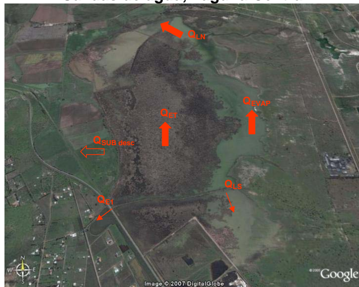
Figura G.2 Salidas de agua, Laguna Central
