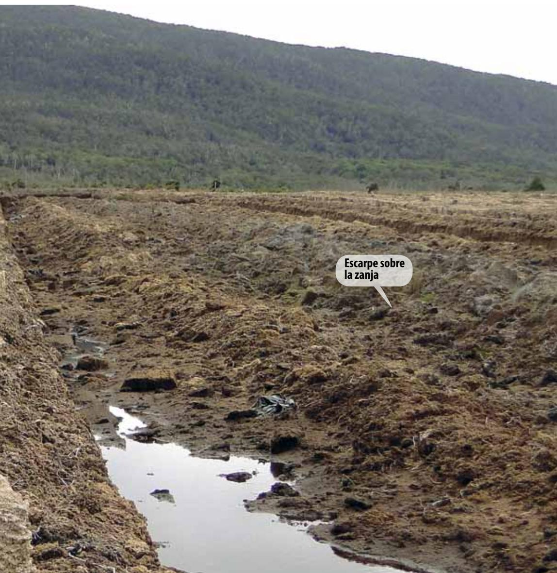
**Figura 6.** Cambios en la topografía generados por la actividad minera de extracción de turba. Se observa una zanja con escarpe y una mocheta con bloques de turba. Estos son los principales agentes de perturbación del paisaje resultantes del proceso de extracción de turba.
