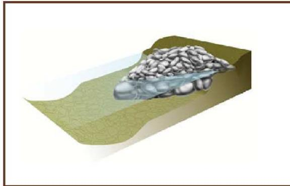
Figura 70: Deflector de corriente de un ala protegido por una malla de alambre.
