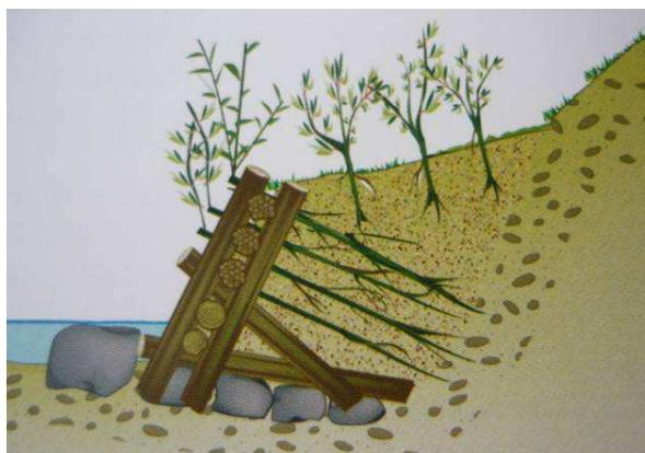
Figura 76: Barreras formando una estructura de troncos dispuestos sobre el talud y anclados con ramas de sauces vivos introducidos en el suelo, sobre una base de piedras que da estabilidad a todo el conjunto.
