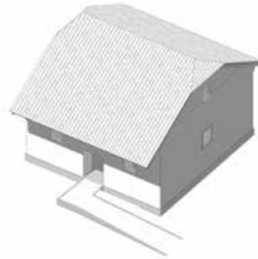
Capa 3 Muros perimetrales y tejuela colonial
