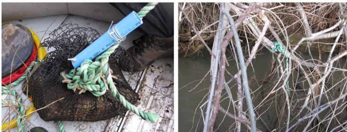
Figura 3-4 Anclaje y ubicación de sensor R-3.
