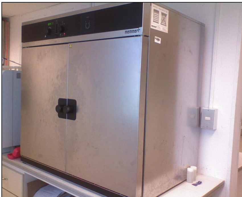
Figura N° 3: Estufa de secado Memmert, modelo UE 600 a 60° C.
