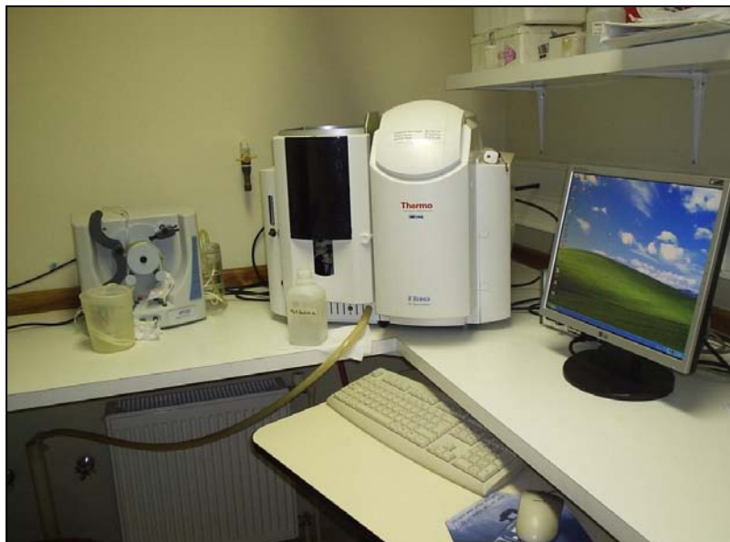
Figura N° 1: Espectrofotómetro de Absorción Atómica, Thermo, modelo S-Series y un generador de hidruros, Thermo, modelo VP-100.
