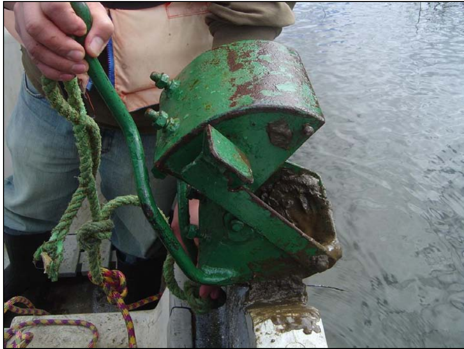
Figura N°5: Draga Emery utilizada para extraer el sedimento del fondo del río.
