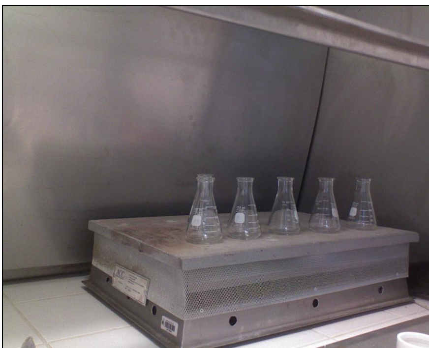
Figura 4: Placa térmica, utilizada para evaporar a sequedad las muestras de agua y para la digestión en placa de los metales en sedimento.
