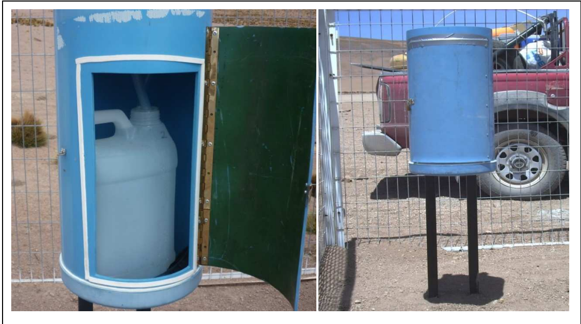
Figura D-3: Colectores de precipitación instalados en terreno
