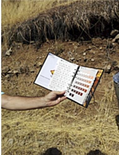
Suelo descrito en el Parque Aguas de Ramón, ubicado en la Quebrada de Ramón. Se describió un suelo en posición de cerros, profundo de origen coluvial sobre el batolito andesítico, presencia de guijarros en todo el perfil, con texturas Franco arenosa a franco arcillo arenosa en profundidad, estructura de bloque subangulares finos a medios fuertes en superficie. Se definió con CCUS VIII.
