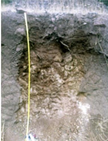
Suelo descrito en el camino que une Machalí con Coya. Suelo en posición de cerros, profundo, formado a partir de la meteorización de la roca de composición principalmente andesítica, con texturas franco arcillo arenosa a franco arcillosa en profundidad, bloques subangulares finos a medio fuertes en superficie a macizo en profundidad. Se definió con CCUS VIII.
