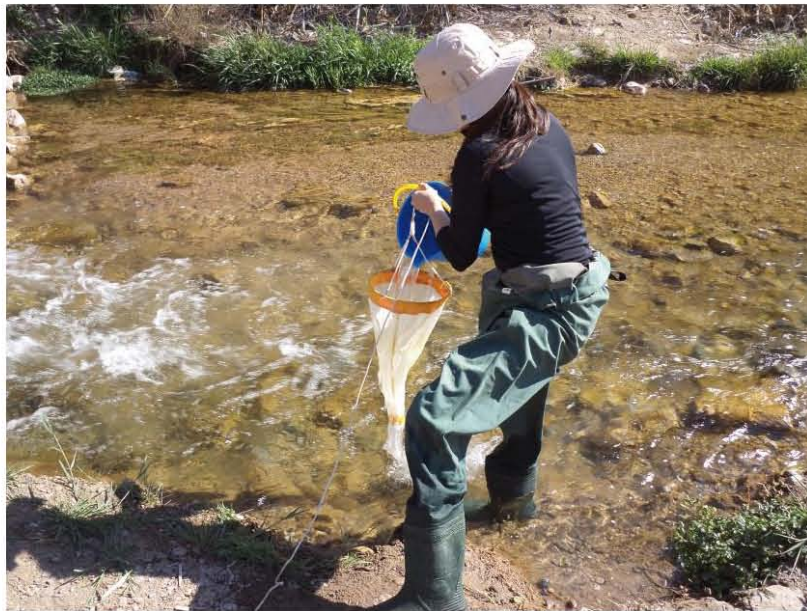
Fotografía N°6: Procedimiento de colecta de fitoplancton (microalgas planctónicas)
