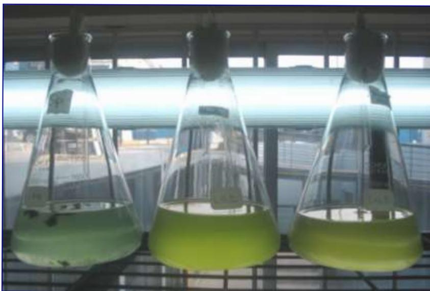
Se obtuvieron cepas aisladas de microalgas y se cultivaron en medios específicos en Batch de 2 litros para aumentar la cantidad de masa recuperada.
